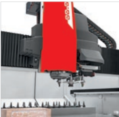
8个工位的上方旋转刀具库, 缩短其更换常用刀具的时间
